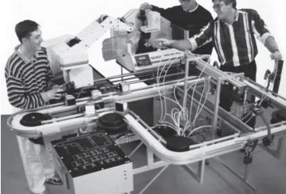
شبیه‌ساز (سیمولاتور) سخت‌افزاری خط تولید در کارخانه
