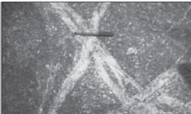
عکس ۱. نمونه‌ای از گرانیته G_2 و شکستگی‌های موجود در آن در خواجه‌مراد
