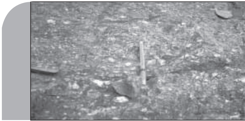
عکس ۵. کنگلومرا رخمونی از کوارتز (نقندر و آغنج) در جنوب غرب مشهد، وجود کوارتز با گردشده‌گی زیاد همراه با سنگ‌های دگرگونی
