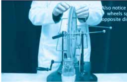
شکل ۱۰- همچنین توجه داشته باشید که چرخ‌های مدور در خلاف جهت یکدیگر حرکت می‌کنند.
