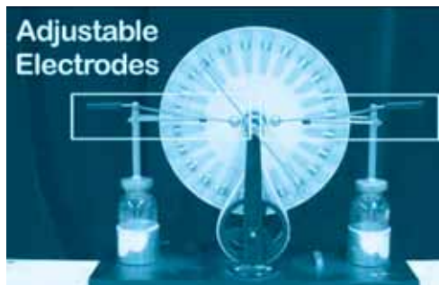
شکل ۸- پایانه‌های (الکترودهای) قابل تنظیم
