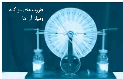
شکل ۵- جاروب‌های دوگانه و میله آن‌ها
