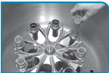
شکل ۴: جداسازی با دستگاه سانتریفیوژ
