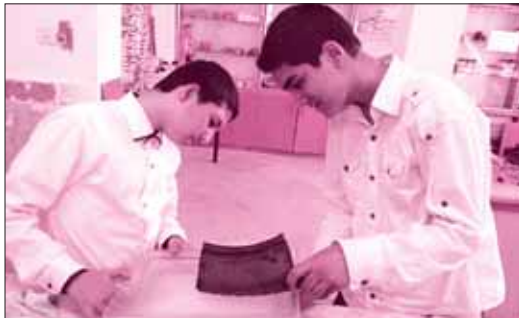
▲ شکل ۲. چگونگی تعیین ضریب اصطکاک ایستایی بین سطح لاستیک (نمونه) و سطح یخی (نمونه)
