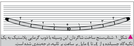
▲ شکل ۱. شتاب‌سنج ساخت شاگردان. این وسیله با ذوب گرمایی پلاستیک به یک تکیه‌گاه چسبانده و از ۴ تا ۴ مایل بر ساعت بر ثانیه، در جهندی شده است.
