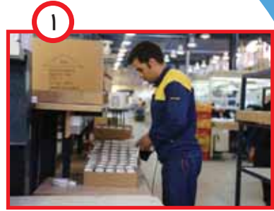
۱ حباب‌هایی که از قبل تولید شده‌اند، این‌جا از نظر سالم بودن، آزمایش می‌شوند.
