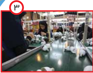
۳ بعد از نصب سرپیچ روی لامپ، نوار نقاله به ادامه‌ی کار تولید، سرعت می‌دهد.
