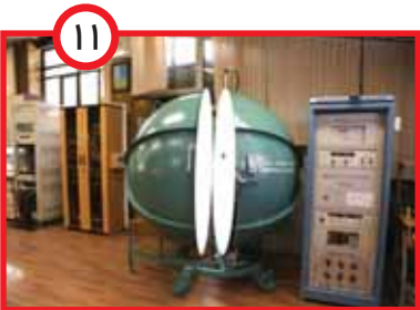
۱۱ شار یا وسعت نوری لامپ، در این وسیله‌ی کرووی اندازه‌گیری می‌شود.
