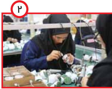
۲ مدار الکترونیکی لامپ با لحیم به لامپ وصل می‌شود.
