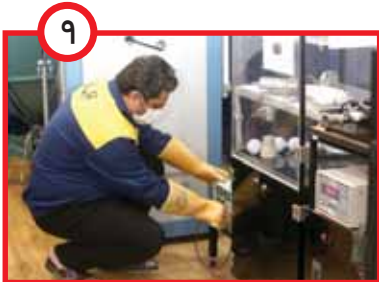
۹ آزمایش‌های استحکام سرپیچ لامپ، تحمل دما و...
