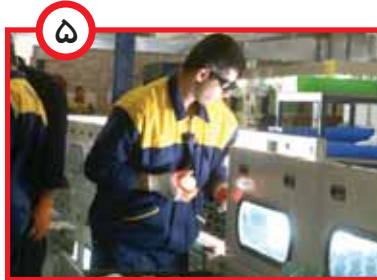
۵ آزمایش دقیق‌تر برای مطمئن شدن از سالم بودن و طول عمر لامپ
