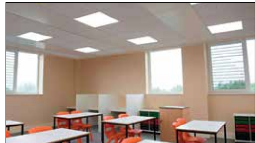
کلاس درس به ۵۰۰ لوکس روشنایی نیاز دارد
