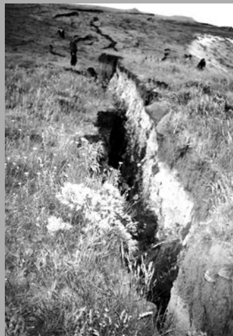
تصویر ۷. شکستگی‌های کششی عمیق در توده لغزش یافته
