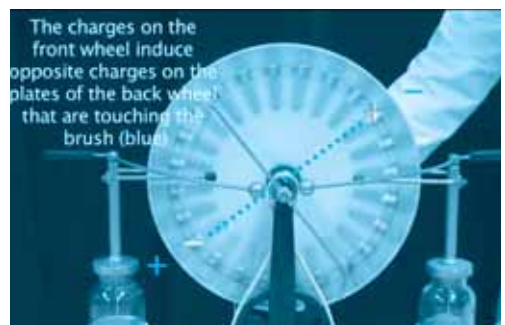
شکل ۱۴- این بارهای مثبت روی «صفحه فلزی کوچک» روی چرخ جلویی، در روی «صفحه فلزی کوچک» روی چرخ پشتی که در تماس با جاروب پشتی است، بار مخالفشان را القا می کنند (بار منفی).
