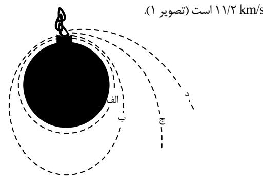
تصویر ۱: ا. اگر یک سوپرمن گلوله‌ای را با سرعت  $8 \text{ کیلومتر در ثانیه}$  از قله کوهی بلند به صورت افقی پرتاب کند، حدود  $90^\circ$  دقیقه بعد می‌تواند دور زمین پرخود و آن گلوله را بگیرد (بنته به شرطی که زمین به دور خود نچرخد).
