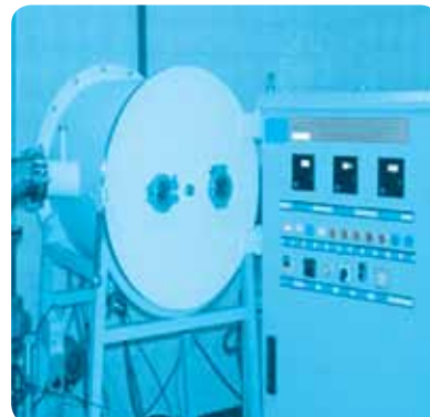
▲ شکل ۴. سامانه کندوپاش دو هدفه
