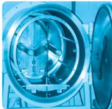
▲ شکل ۴. سامانه کندوپاش دو هدفه
