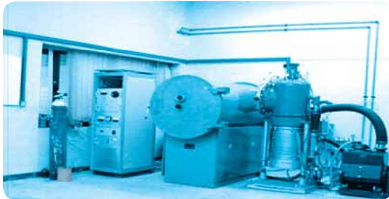
▲ شکل ۳. سامانه اسپاترینگ یک هدفه
