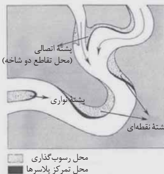
شکل ۲. محل تمرکز پلاسرها در ارتباط با مئاندرهای رودخانه‌ای، محل اتصال رودها و انواع پشته‌ها (اقتباس از: منبع ۵۶، ص ۲۰۵)
