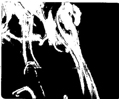
شکل ۳. جریان‌های دود از سرچوب‌های عود تا نقطه‌ی معینی به صورت لایه‌ای بالا می‌روند و سپس متلاطم می‌شوند.
