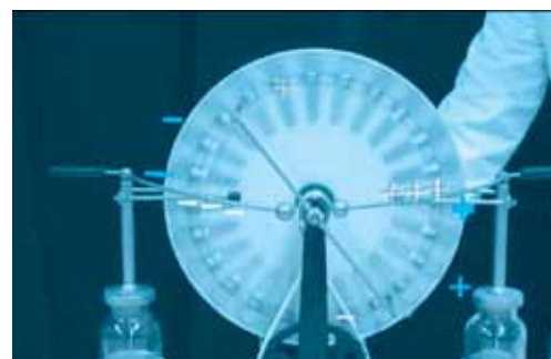
شکل ۱۸- فرآیند جمع شدن بارهای مثبت و منفی را در دو الکتروود مشاهده کنید.
