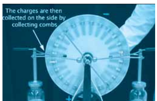
شکل ۱۵- سپس بارها به وسیله شانه های جمع کننده در بطری های لیدن دو طرف جمع می شوند.
