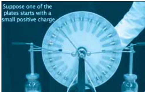
شکل ۱۱- در شروع فرض کنید یکی از «صفحات فلزی کوچک» در تماس با جاروب دارای بار مثبت می‌شود.
