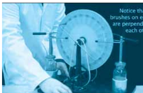
شکل ۹- توجه داشته باشید که میله‌های جاروب‌ها در دو طرف دستگاه برهم عمودند (منظور میله مربوط به جاروب‌های چرخ مدور جلویی و میله مربوط به جاروب‌های چرخ مدور پشتی است).
