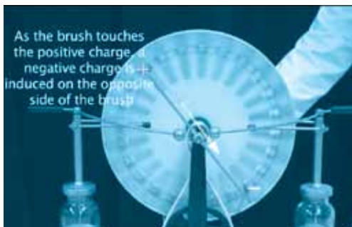
شکل ۱۲- این عمل موجب ایجاد بار منفی در «صفحه فلزی کوچک» در طرف دیگر میله جاروب می‌شود. (توجه داشته باشید که میله‌های جاروب‌ها در چرخ‌های دوطرف، در وسط به زمین اتصال دارند).
