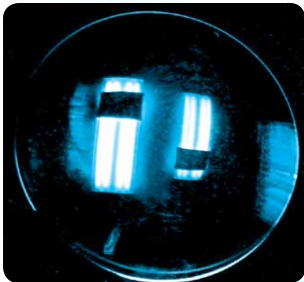
شکل ۲- تصویرهای چراغ بالای سر که از جلو و عقب سطوح یک عدسی دو کوژ باز می‌تابد. ورقه آلومینیمی که در یک انتهای چراغ قرار گرفته وارونه شدن تصویر را نمایان می‌سازد.
