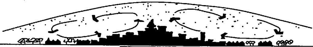
شکل ۱) شهرها به وسیله یک توده هوای گرم محصور شده اند که ارتفاع آن به طرف مناطق روستایی کاهش می یابد.
